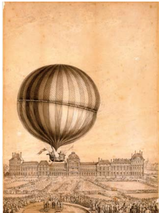
Gasballon von Jacques Alexandre César Charles. Alle Arten von Ballonen sind zunächst leichter als Luft und steigen hoch. Irgendwann will der Ballonfahrer jedoch das Steigen beenden oder wieder landen. Soll der Ballon sinken, muss er schwerer als Luft werden. Beim Heißluftballon lässt man die Luft abkühlen, beim Gasballon lässt man Gas ab
