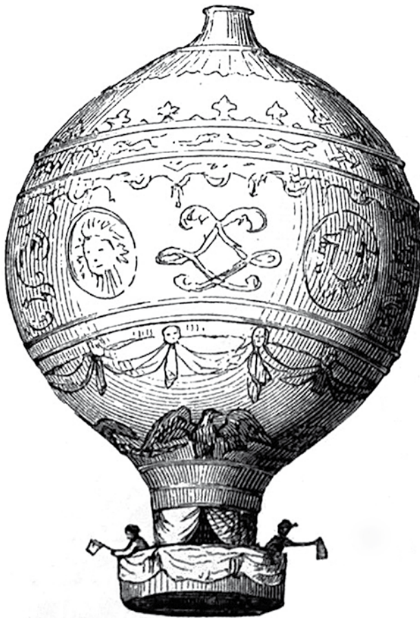
Montgolfière. Sie hatte noch keinen Brenner wie heutige Heißluftballone, höchstens eine Metallpfanne, in der man etwas brennbares Material zur Erzeugung zusätzlicher Heißluft hatte. Einmal mit Heißluft gefüllt, stieg sie solange, bis die Luft innen abkühlte
